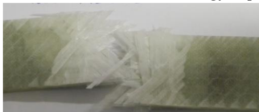
80. ábra. A quadriaxiális erősítésű kompozitlemez tipikus tönkremenetele
