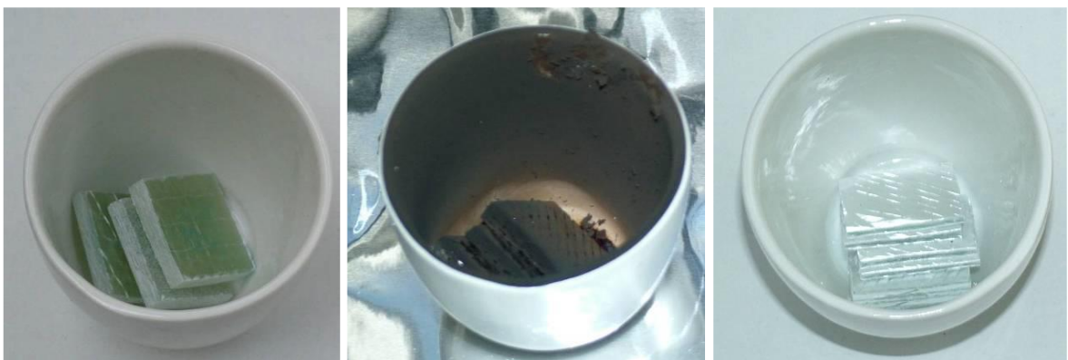
76. ábra. Minta a kiégetés előtt, kiégetés után, valamint az izzítás után
