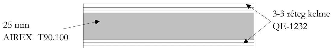
15. ábra. A vizsgált szendvicsszerkezet felépítése
