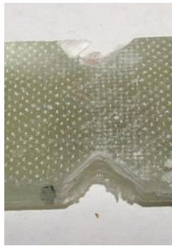
81. ábra. Nyíróvizsgálati próbatest bemetszett része a mérés után
