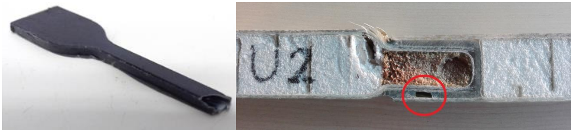
78. ábra. Légzárvány a ragasztó anyagában U-kötés esetén
