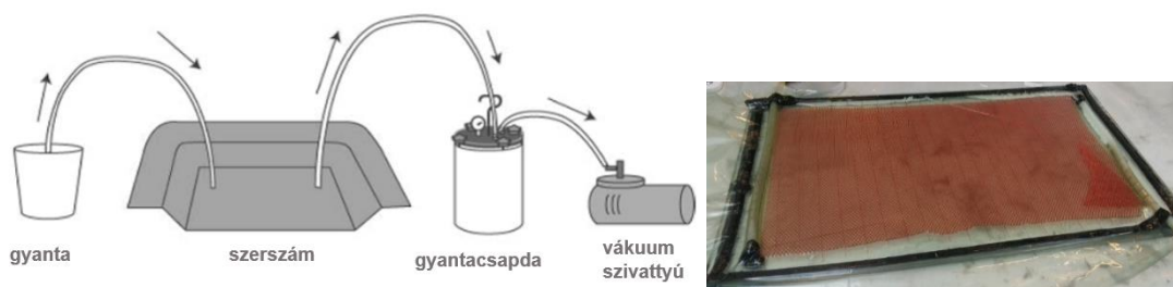
12. ábra. Vákuuminfúzió folyamatának sematikus ábrája a) a gyártás alatt lévő síklap b)
