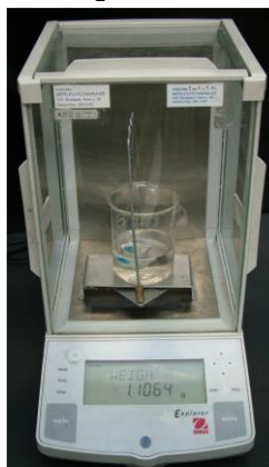
75. ábra. Tömegmérés elrendezése folyadékba merítés közben
