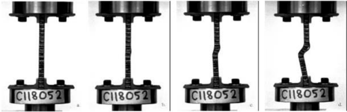
47. ábra. Szendvics próbatest kihajlása nyomóterhelésre [137]
