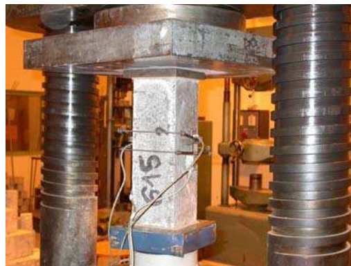
3.5. ábra A próbatest helyzete a törőgépben
