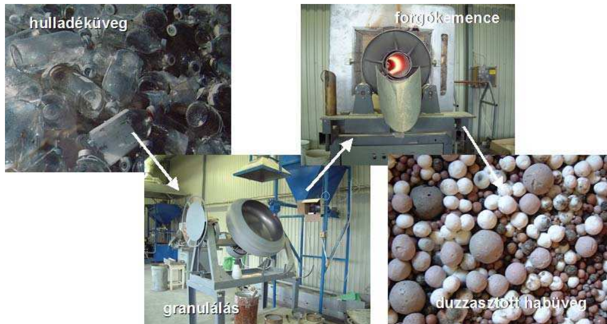
1.11. ábra „Geofil-Bubbles” habüveg gyártási vázlata
