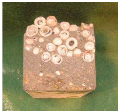
5.5. ábra A könnyű adalékanyag felúszása nem megfelelő konzisztencia és tömörítés esetén
