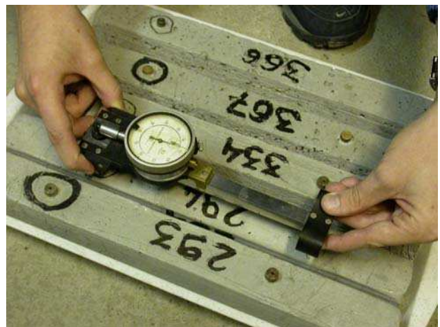
3.8. ábra A zsugorodás ill. hőtágulás mérése Demec típusú mérőeszközzel (1 napos kortól)
