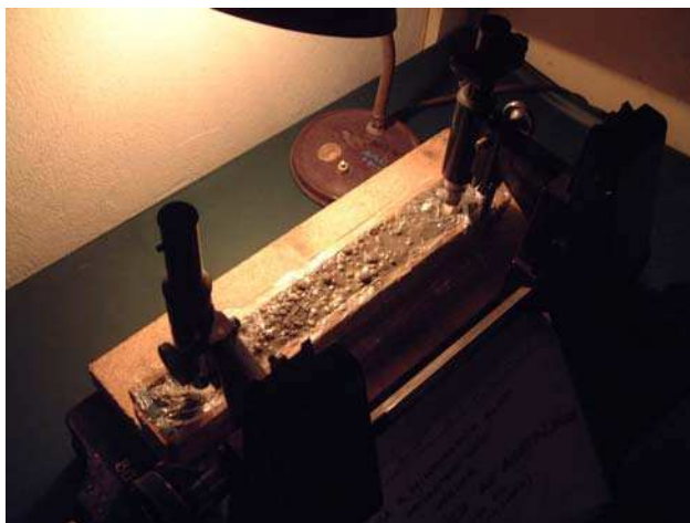
3.7. ábra Zsugorodás mérés Leitz-Wetzlar készülékkel (24 órás korig)
