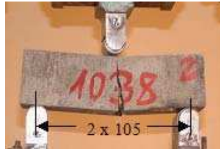
3.4. ábra A hajlító vizsgálat
