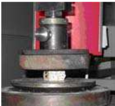
3.2. ábra Adalékanyagok szilárdságvizsgálata szilikonpróbatesttel
