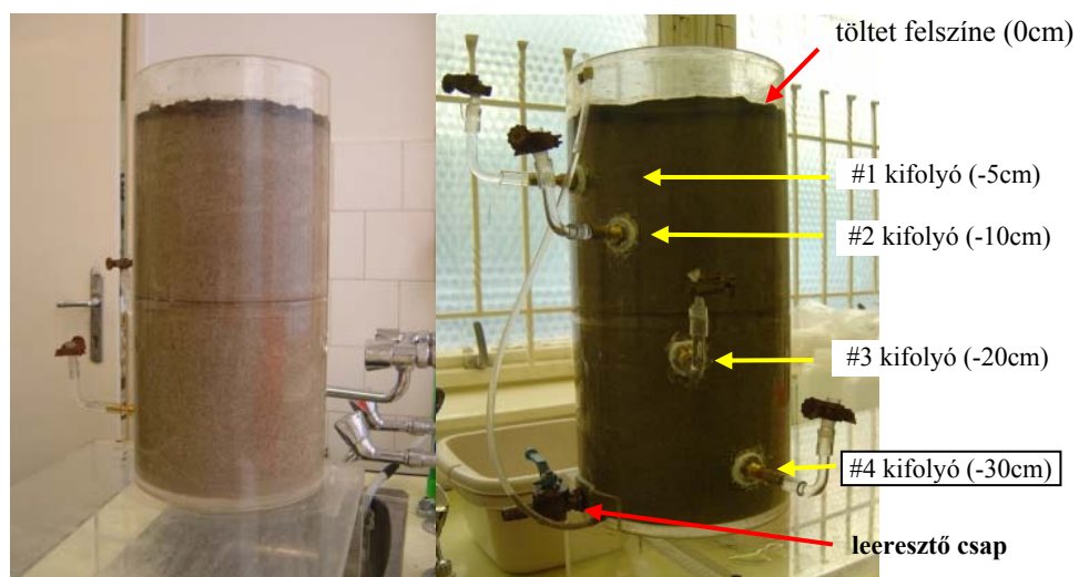
6-5. kép: A szűrőberendezés felépítése
