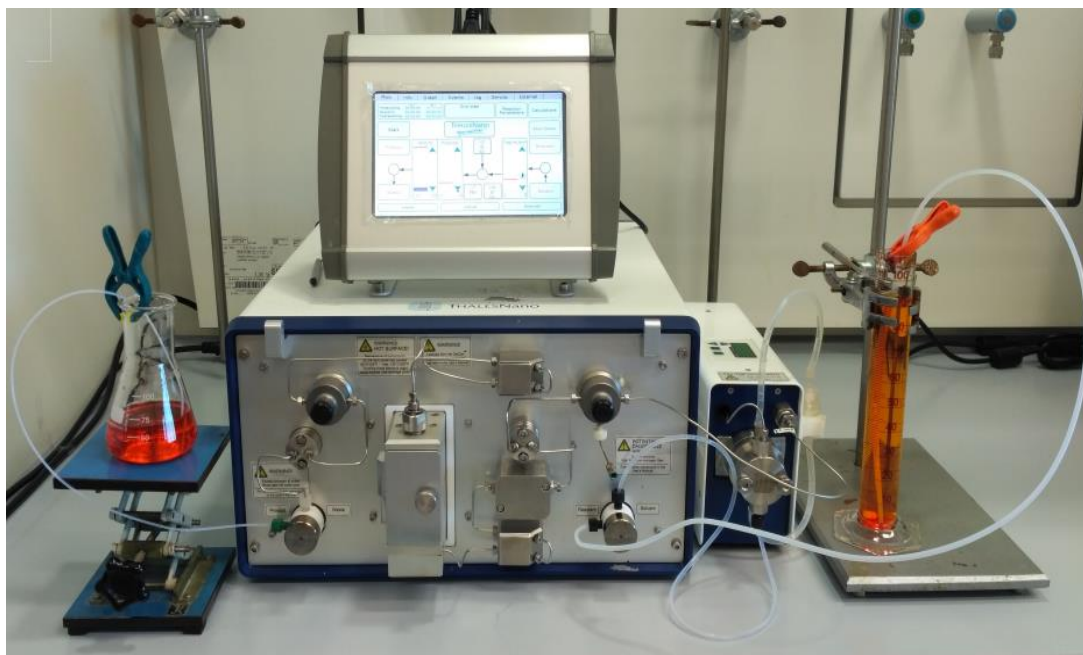
11. ábra: H-Cube Pro, folyamatos áramú hidrogénező berendezés
