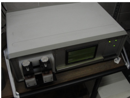
3. ábra: A termofeszültség-mérő készülék és kapcsolási vázlata
