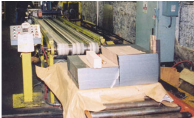
2. ábra A fő vezérlőtábla a sor végénél van, ahol a kezelő a készterméket távolítja el.
