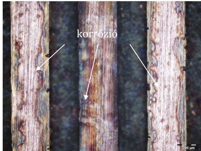
40. ábra. Kémiailag tisztított réz mérőlemez WD teszt után; optikai mikroszkópos felvételen korróziós nyomok láthatók.
