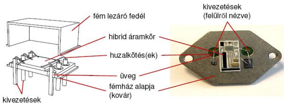
10. ábra. Fém-üveg kötéssel lezárt hermetikus tokozás [107].
