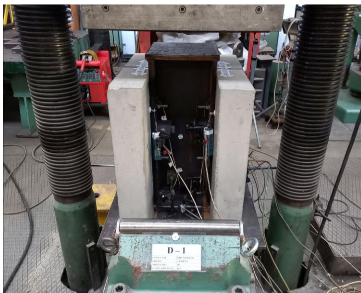
4. ábra: Egy előkészített kinyomókísérleti próbatest
