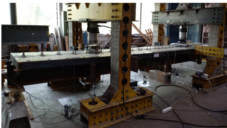
11. ábra: DC4-G próbatest vizsgálati elrendezése – terhelőkeretek és mérőberendezések
