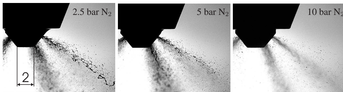
4.1. ábra. Repceolaj-porlasztás a segédkezes porlasztóval. Porlasztási nyomás: 5 bar. N 2 segédkezes nyomása 2,5, 5 és 10 bar
