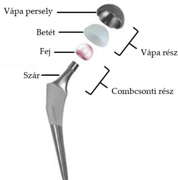
17. ábra. A primer teljes konvencionális csípőimplantátum részei [SportsmedsaND]
