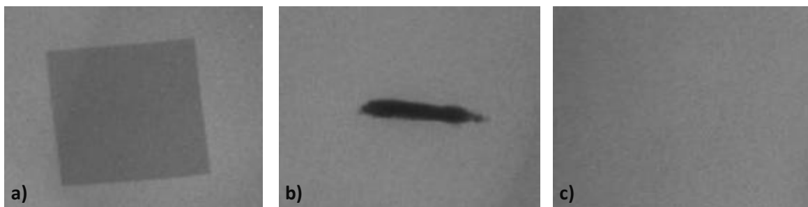
43. ábra: a) Acéllemez, b) Ta-por, és c) mintát nem tartalmazó háttér angiográfias felvételei (80-120 kV gyorsítófeszültség tartomány)
