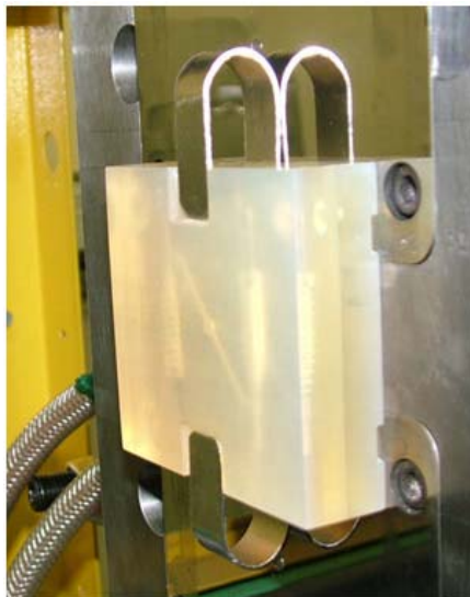
4. ábra Fröccsöntőgép álló oldali szerszámfelfogólapjára rögzített, összeszerelt fröccsöntőszerszám
