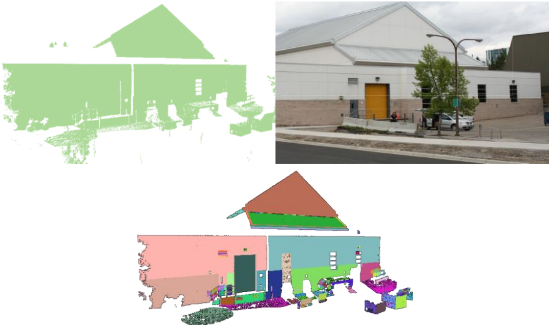
17. ábra. 3D pontfelhő (bal felül), színes kép (jobb felül), szegmentált síkok (alul) (Lari et al. , 2011)
