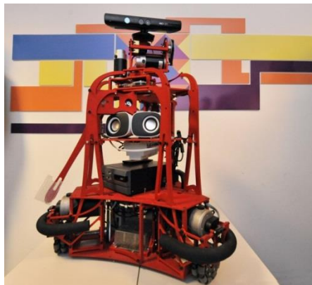
25. ábra. Kinect a BME MOGI – MTA-ELTE Összehasonlító Etológiai Csoport (MAT: 01 031) által épített roboton
