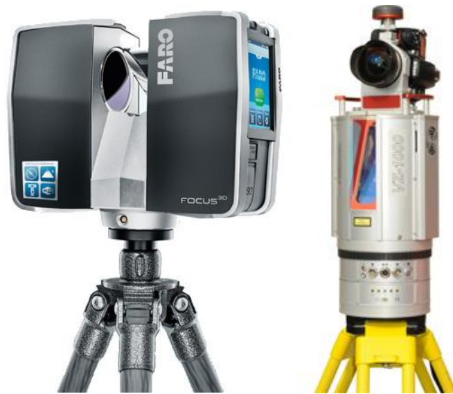
15. ábra. Földi lézerszkennerek: Faro Focus 3D (balra), Riegl VZ-1000 (jobbra)
