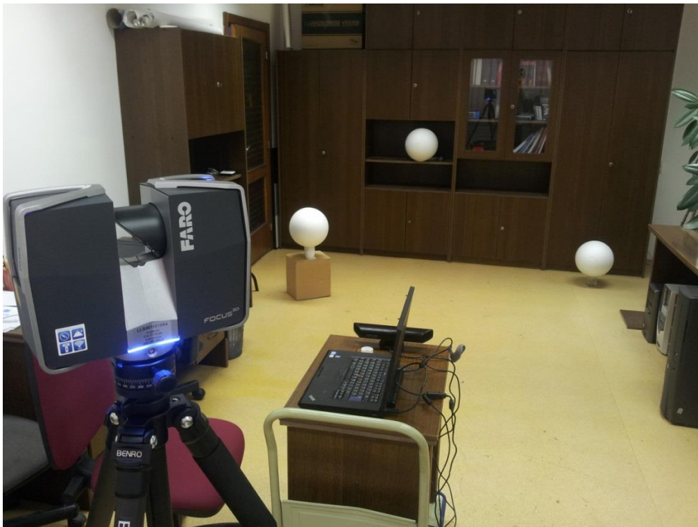
50. ábra. Faro lézerszkenneres mérés a minősítéshez
