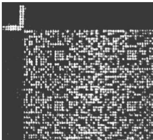
7. ábra Konstans súlyú véges állapotú kódolással készült hologram képe
