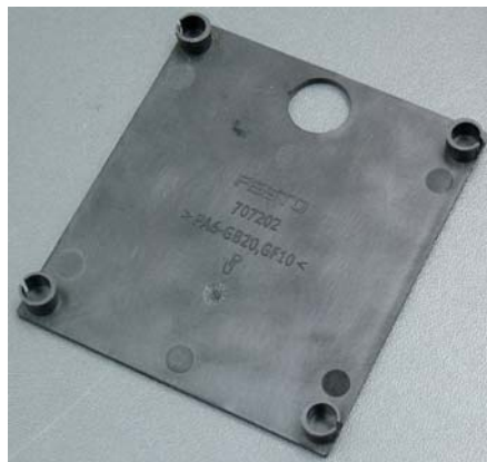
91. ábra 30 m% bazaltszállal erősített és erősítetlen PA6-ból fröccsöntött fedelek hátoldala
