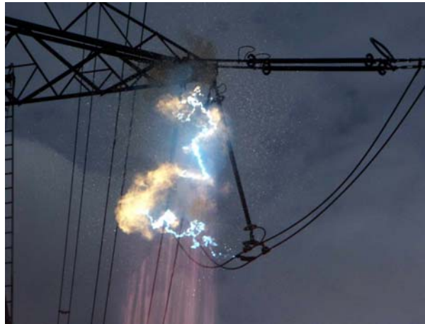
9-24. ábra – A 2*400 kV-os Hévíz-Tumbri távvezetéken 2004. május 25-én elvégzett kísérlet során keletkező szekunder ív [41]
