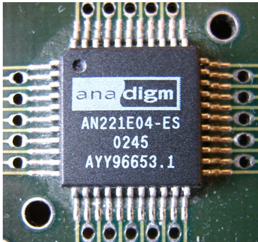
4.9. ábra. Az Anadigm legelterjedtebb programozható analóg áramköre.
