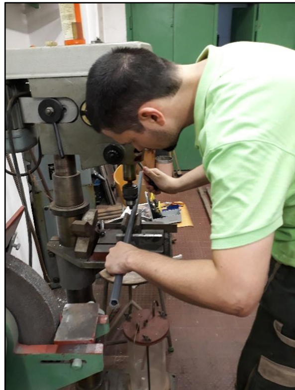
Melléklet 9. ábra: Kút perforálása a laborbeli fúrógéppel
