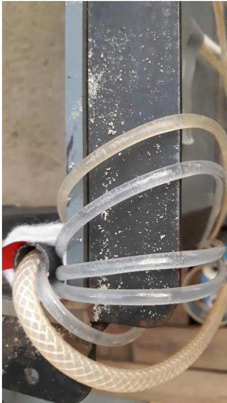
Melléklet 11. ábra: A kút melletti piezométerekben felgyülemlt levegőbuborékok
