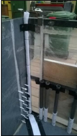
3. kép: Az oldalfali piezométerek, az anyakút és a megfigyelőkutak elhelyezkedése a modell belsejéből szemlélve (2015)
