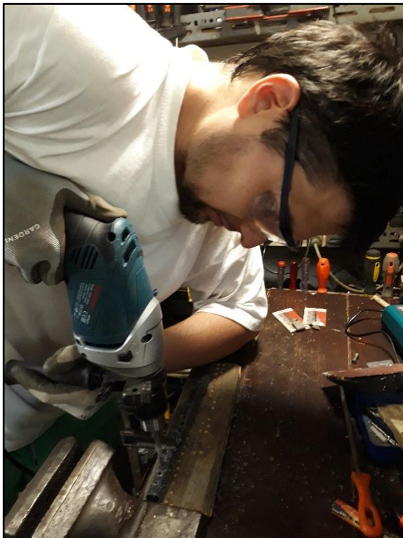
Melléklet 8. ábra: Kút perforálása kézi fúrógéppel
