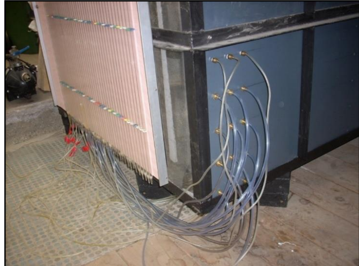
4. kép: Az oldalfali piezométerek bekötött állapotban a piezométertáblába (2015)
