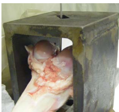
63. ábra PLA csavar sertéscombcsontból történő kiszakítása
