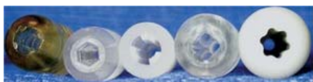
15. ábra Csavarokban alkalmazott belső kulcsnyílás geometriák (balról jobbra) (kereszt, imbusz, trilobe, négyzet, torx [83])
