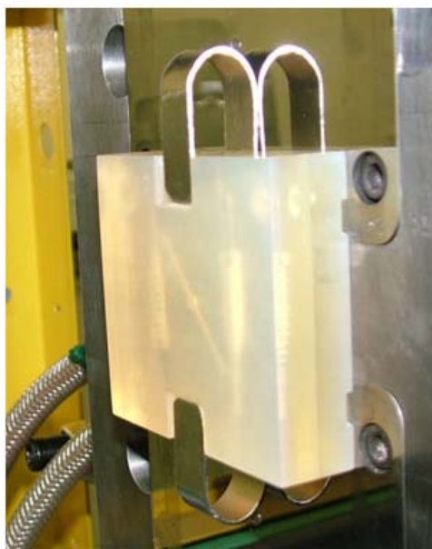
50. ábra Fröccsöntőgép álló oldali szerszámfelfogólapjára rögzített, összeszerelt fröccsöntőszerszám
