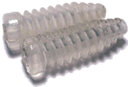
51. ábra Politejsavból polimer szerszámba fröccsöntött csavarok
