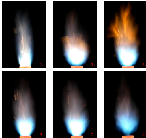
4. ábra. A lángfúvás képsora az eredeti égő esetén, p_g = 0.7 bar.
