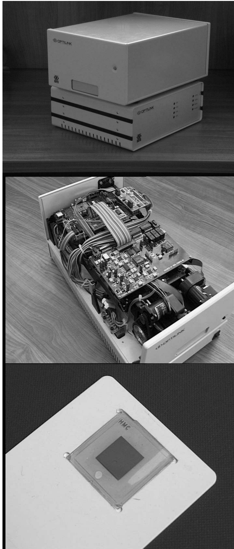
3. ábra A HMC rendszer képei, az író-olvasó készülék és a tápegysége, a csak olvasó készülék kinyitott állapotban, és az adattároló kártya.
