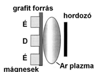
3.2. ábra. Magnetron porlasztás vázlata.
