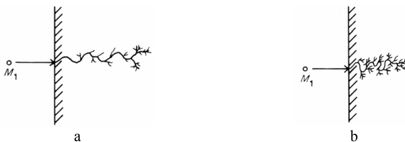
3.14. ábra. A céltárgy atomjainál könnyebb (a) és nehezebb (b) implantáló ionok fékezésének szemléltetése [Ryssel1986].
