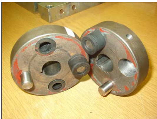
8. ábra Gumidugós rugalmas tengelykapcsoló
