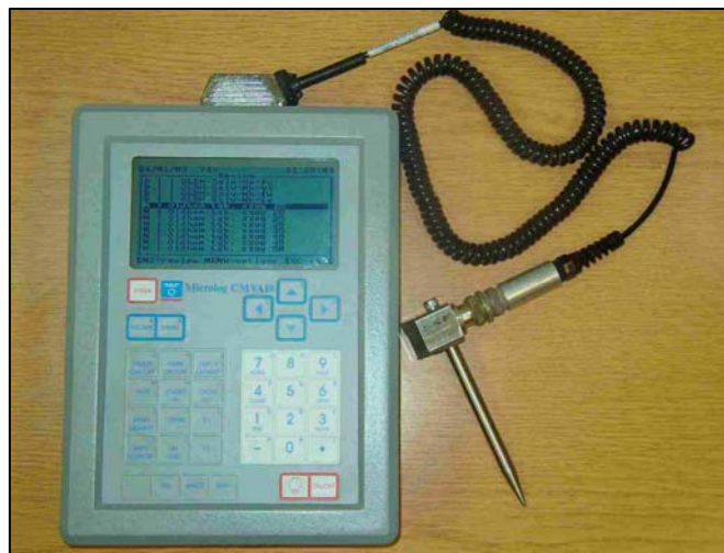
12. ábra SKF Microlog CMVA 10 rezgésmérő és -analizáló
