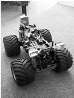
4.1. ábra CCEXplorer első verziója előrenéző kamerával és a körbélátó rendszerrel
