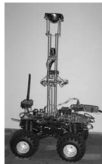
4.1. ábra CCEXplorer első verziója előrenéző kamerával és a körbélátó rendszerrel
