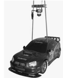
3.5. ábra Modellautóból átalakított robot PAL-optikával: PALCOM
