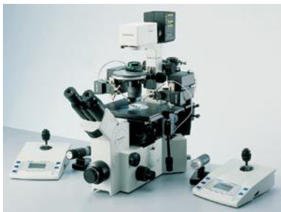
a) Eppendorf TransferMan NK 2 mikromanipulációs munkaállomása
