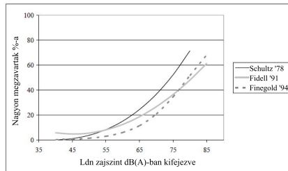
1. ábra. A közlekedési zaj zavaró érzetének közelítése Schultz (1978), Fidell és Barber (1991), Finegold et al. (1994) által kidolgozott görbékkel (Kempen et al., 2005) (A feliratok a szerző fordításai.)
