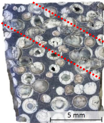
3. Az Al99,5-GC típusú szintaktikus fémhab hosszmetzeti csiszolatának mikroszkópos felvétele a fásztást követően.
