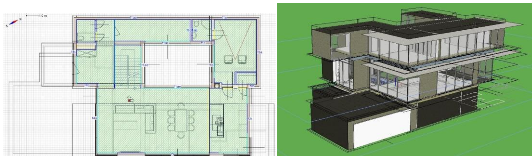
2. ÁBRA – ALAPRAJZI ZÓNÁZÁS ÉS 3D NÉZET AZ ENERGIAMODELLRŐL AZ IDA ICE SZOFTVERBEN
