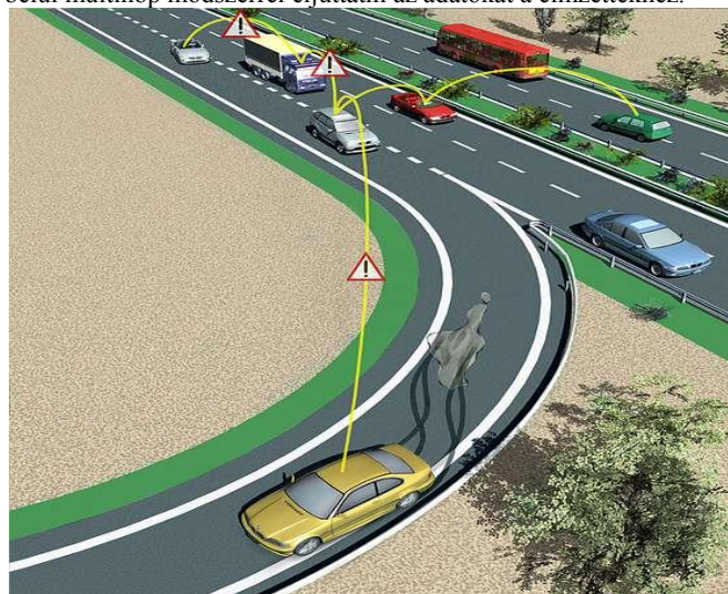
3. ábra: A veszélyes helyre figyelmeztető alkalmazás működése (forrás: http://car-to-car.org )
