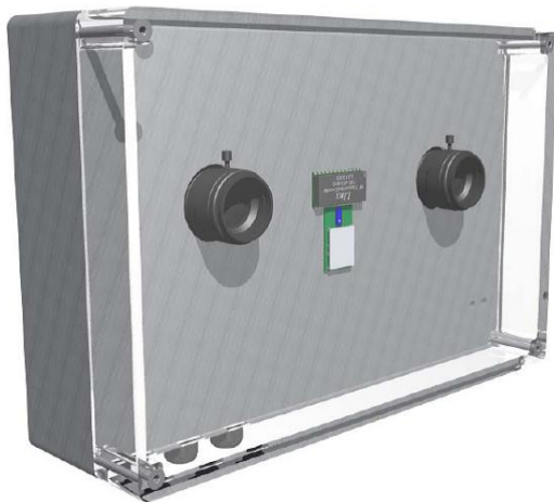
2. ábra: Sztereó ATC érzékelő CAD rajza
