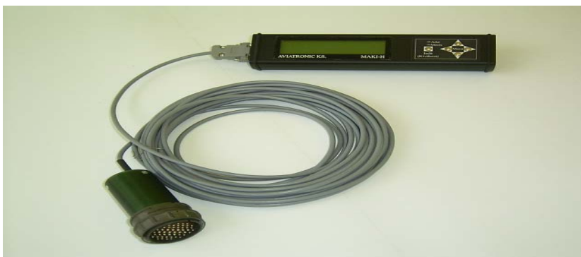
4. ábra: Mérési csatorna Hitelesítő-kezelő berendezése – MAKI-H.
