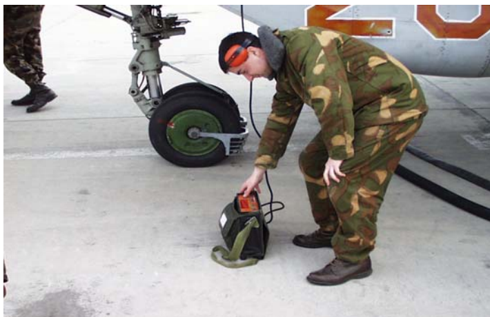
2. ábra: MAKI – Mobil Adatkiolvasó és gyorskiértékelő berendezés kezelőszerve csatlakoztatás módja – adatkiolvasás.
