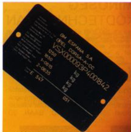
1. ábra: Gép adattábla feliratozása (festékréteg eltávolítása)
