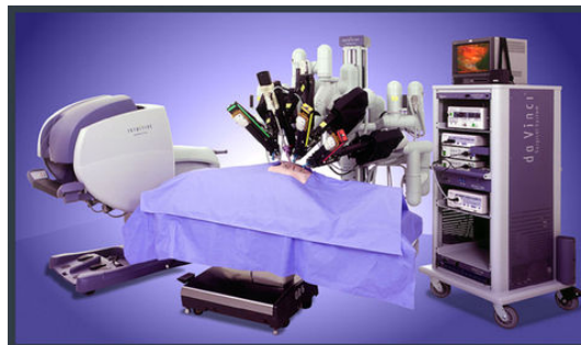
1. ábra A da Vinci komplett tele-operációval működtethető robotrendszer
