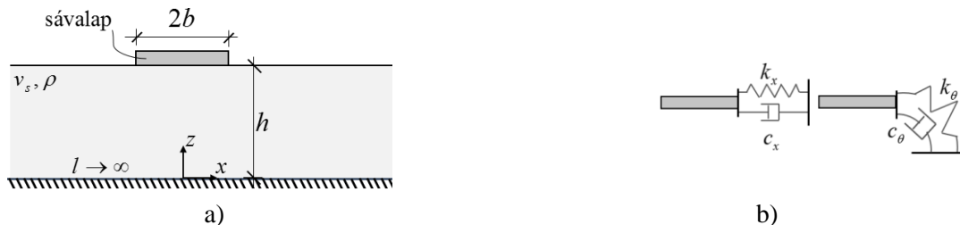
3. ábra a) Vertikális értelemben véges h vastagságú talajréteg és merev sávalap, b) konstans rugó- és csillapítóelemből álló rendszer
