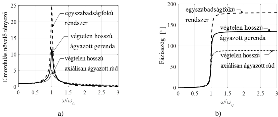
2. ábra a) Nagyító tényező és b) fáziseltolódás egyszabadságfokú rendszer, végtelen hosszú ágyazott rúd és végtelen ágyazott gerenda esetén, \zeta=2\%
